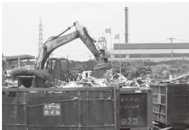
鉄リサイクルの現場では、大型機械による選別から始まり、リサイクル用途によってさらに細かく分類される工程を見学しました。
