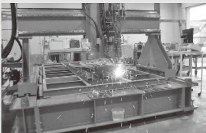
ガストーチを用いた自動切断装置
