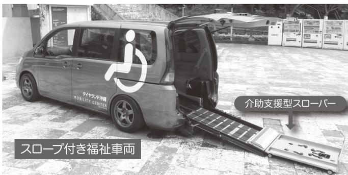
図2 介助支援型スローパーを取り付けた福祉車両外観
