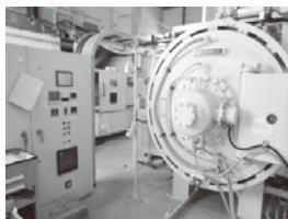
真空熱処理炉(中日本炉工業:MF-300-PC)
