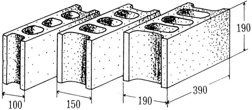
◆C種空洞コンクリートブロック(横筋型)◆
