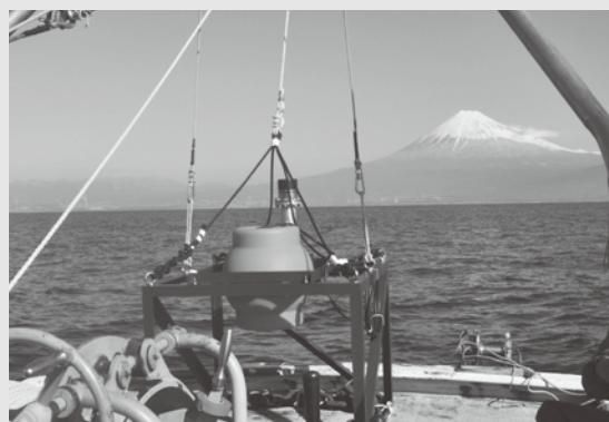
図2. 深海1000mに沈める送信装置
